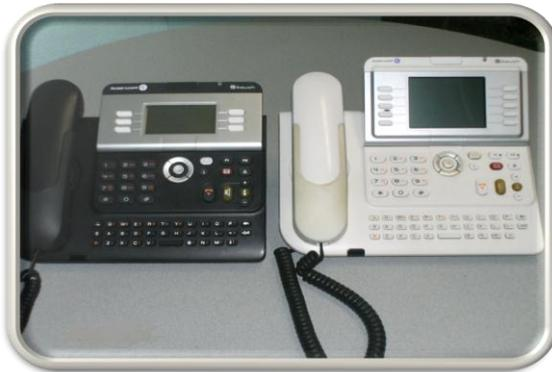
solución convergente de voz y datos que incluyó la actualización de la red de voz y datos instalada en la institución. El hardware y software que se instaló es 100% telefonía IP (Protocolo de Internet). El sistema está basado en estándares y protocolos establecidos por la industria para el manejo de la telefonía IP tales como H323 y SIP.
